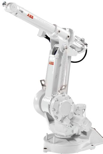
IRB 1410工作周期短、运行可靠，能助您大幅提高生产效率。该款机器人在弧焊应用中历经考验，性能出众，附加值高，投资回报快。
